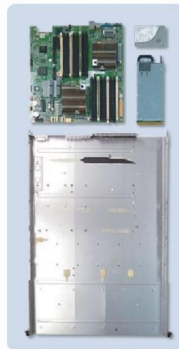
▲ 液浸用服务器部件的构成（例）
